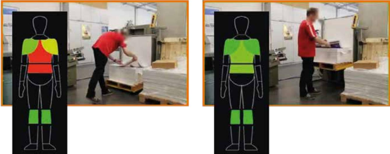
Ohne zusätzliche Sensoren, die als Marker am Körper angebracht werden müssen. Messung der Praxissituation direkt am Arbeitsplatz, ohne zusätzliche Störung des Arbeitsablaufs. Es wird keine aufwendige Laborsituation benötigt.
